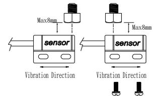
Geschwindigkeitssensor und Magnethalterung:
